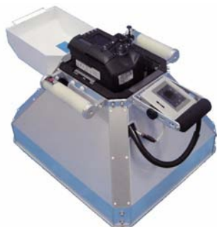
図2 単眼タイプ撮影装置 (改良型)
