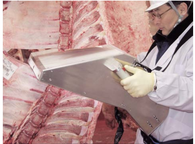
図6 薄型撮影装置による作業風景
