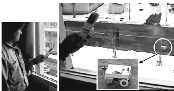
図10 携帯電話からの遠隔操作試験
