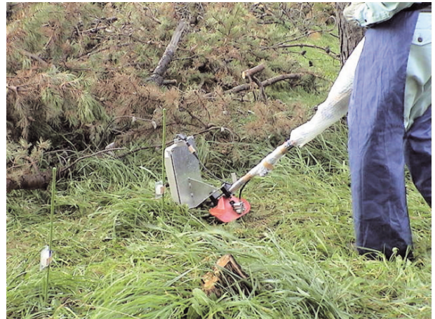
図21 誤刈り防止機能付手動下刈り機の作業試験
