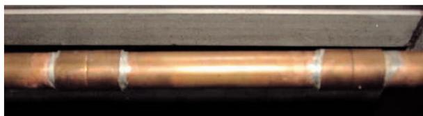
図5 軟ろうで溶接した試験体
