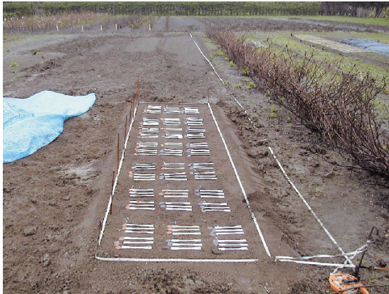
図2 土中埋設試験(道立林業試験場道北支場)
