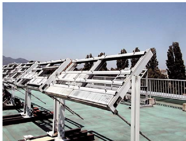
図1 屋外暴露試験(道立工業試験場屋上)
