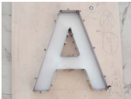
図9 散光板の試作実験例
