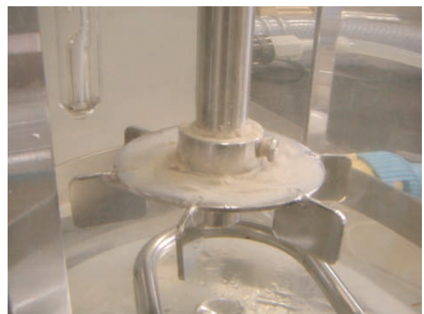
図16 攪拌羽根への菌体付着
