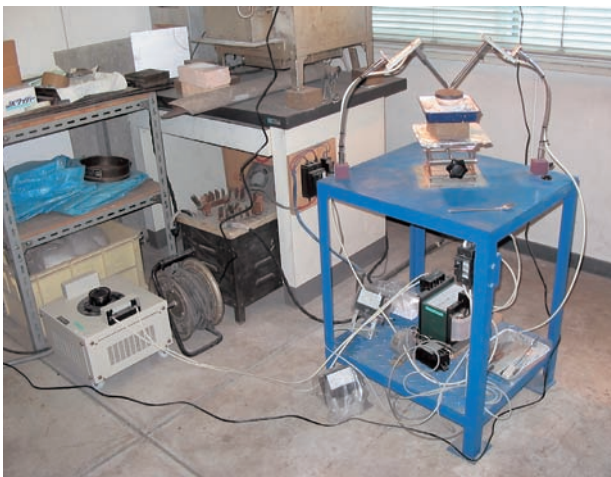
図2 電気抵抗式溶融法による加熱還元気化実験装置の回路模式図
