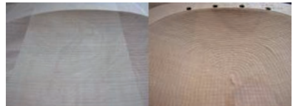
図18 平行軌道とU字型軌道の切削面
