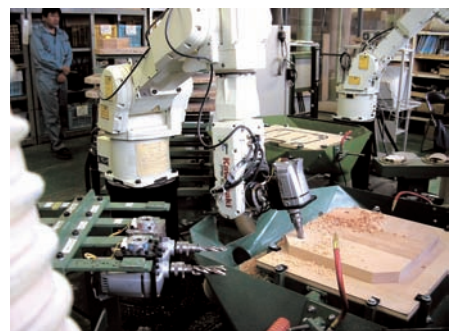
図15 マニピュレータロボットによる穴あけ加工の様子
