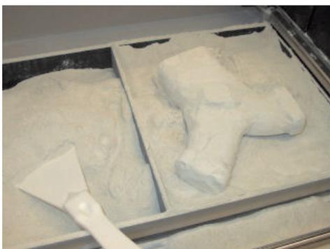
図15 粉体積層RP成形体の取り出し
