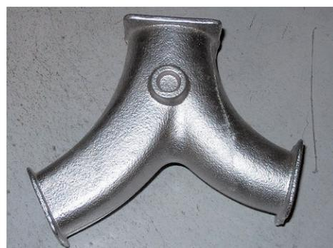
図17 鋳物表面の溶湯金属の差込み欠陥
