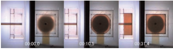
図5 モデル実験の様子（肉厚3 mm, 粘度300 cP）
