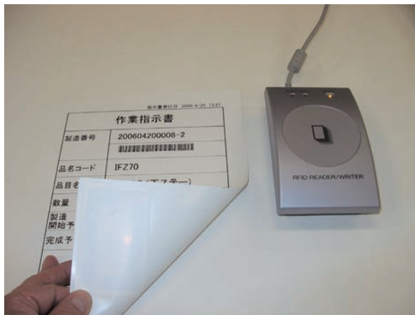
図11 タグ付き作業指示書とリーダ/ライタ
