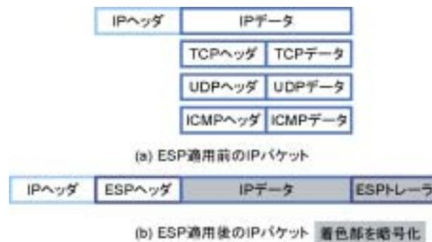
図2 ESP適用前後のIPパケット
