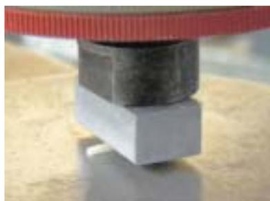
図17 神経再生チューブの偏平試験
