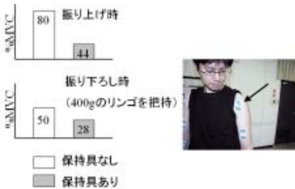
図18 筋電図(左三角筋)による保持具の効果検証
