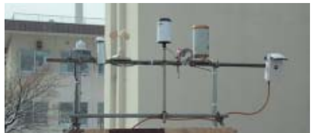
図6 気象観測・路面監視用計測器
