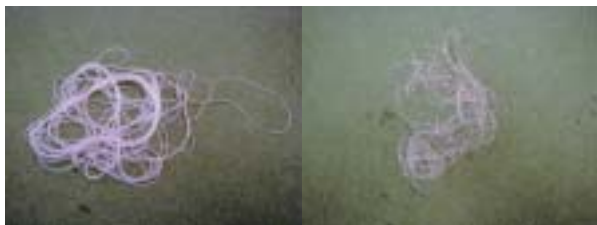
図3 各凝固浴でのセルロース繊維 (左側：蒸留水、右側：メタノール)
