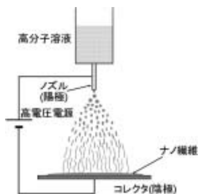
図1 エレクトロスピンニング概念図
