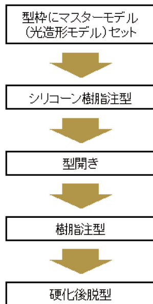
図13 コピー部品の作製フロー
