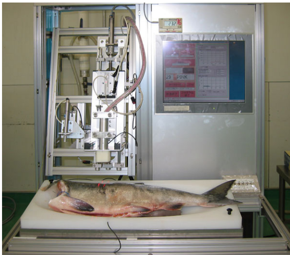
図10 鮭等級判別装置（試作機）
