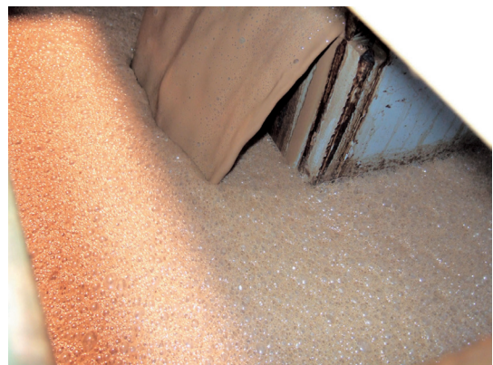
図5 長時間電解時に大量に発生した泡の状態
