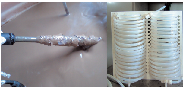
図7 エクス化処理試料の保温方法 (左図：焼き付いたヒーター、右図：自作熱交換機)
