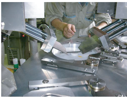
図24 円筒面状の刃物による裁断機構
