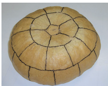
図22 多くの切片が四角錐台状になる裁断軌道
