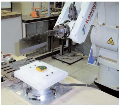
図16 多関節ロボットによる裁断試験
