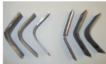
b) 曲げ試験後の試験片
