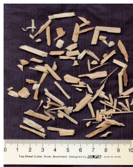
図6 担体散水型好気性処理試験に用いた木質破砕物
