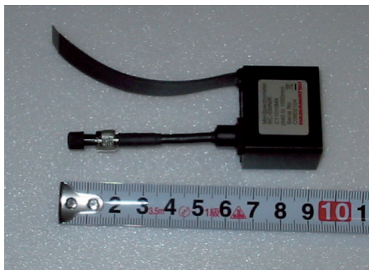
図14 ミニ分光器（浜松ホトニクス C11010MA）
