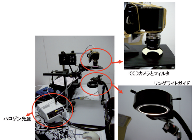
図4 ハロゲンリングライトを用いた撮像系
