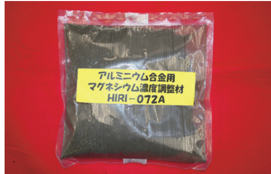
図9 開発したMg濃度低減用フラックス
