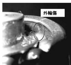
図1 設備の異常例 (軸受の外輪傷)
