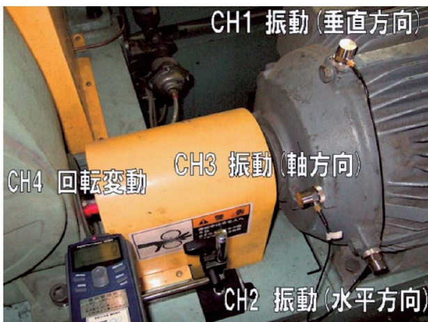
図10 モータ軸受測定
