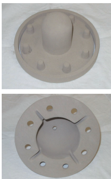
図13 粉末積層成形技法で成形した試験用鋳型
