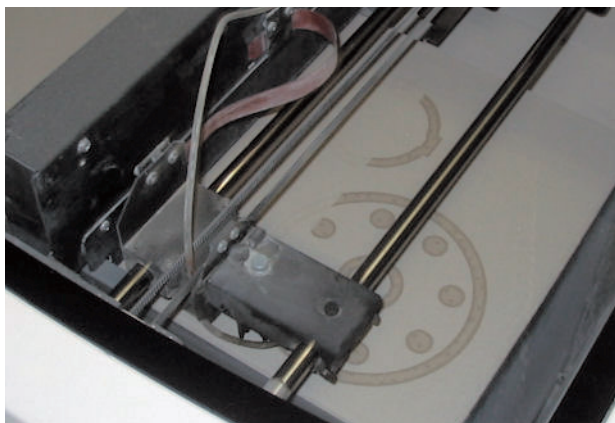
図12 試作粉末JOLivine613による積層成形試験
