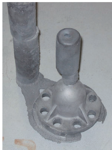
図14 試験用鋳型で铸造した鋳鉄鋳物の外観 (材質：FCD450相当品)
