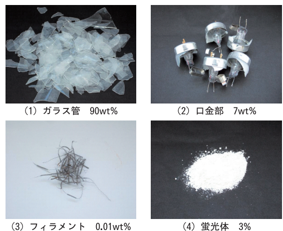
図9 使用済み蛍光管の構成部位
