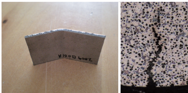
図11 曲げ加工結果（左：外観、右：組織）
