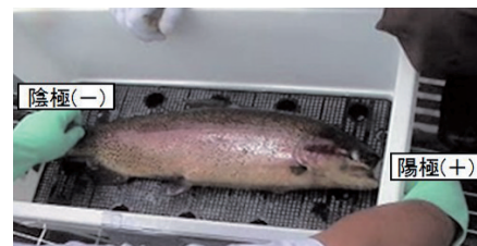
図8 ニジマスの通電試験
