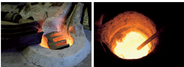
Fig. 1 火格子の溶解 Fig. 2 溶湯への酸素吹き込み
