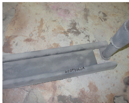
図2 鑄造試験により得られた鑄物
