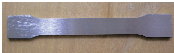
図4 引張試験片（上：形状，下：外観）
