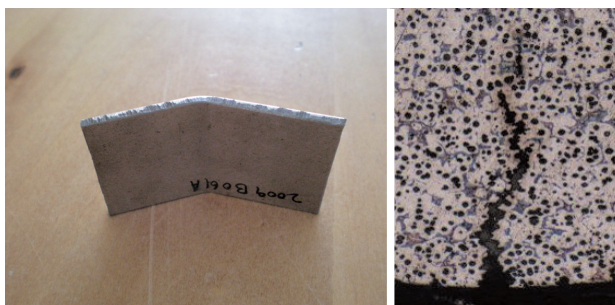
図11 曲げ加工結果（左：外観、右：組織）
