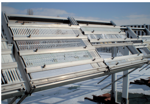
図1 屋外暴露試験（札幌市内 工業試験場屋上）
