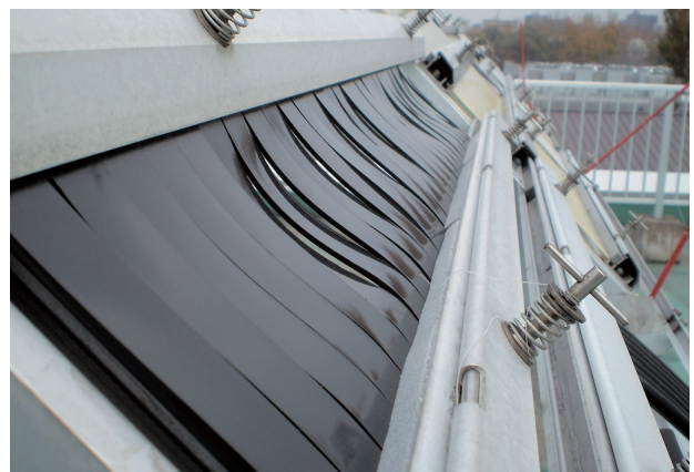
図12 ポリ乳酸黒色試験片の屋外暴露状況
