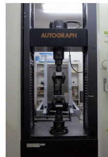
図7 引張試験状況
