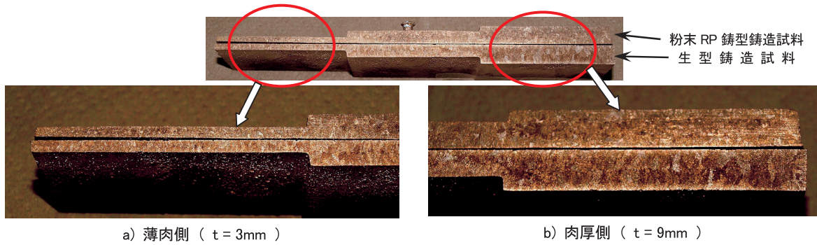
図10 生型と粉末RP鋳型で鋳造した銅合金鋳物のマクロ組織観察
