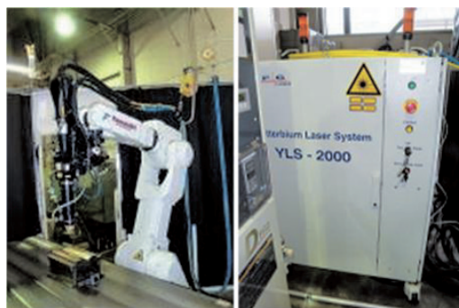
図4 レーザ加工装置外観 (左：レーザーヘッド部 右：レーザー発振器)
