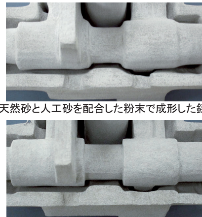
b) 細粒人工砂を用いた粉末材料で成形した鋳型
