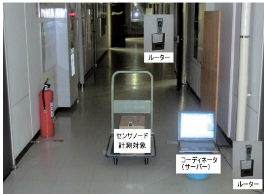
図6 廊下移動計測試験風景
