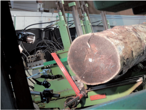
図6 樹心にチョークで印をつけた原木木口面の例
