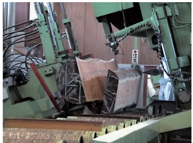
図2 送材車付き傾斜帯のご盤を使った製材
