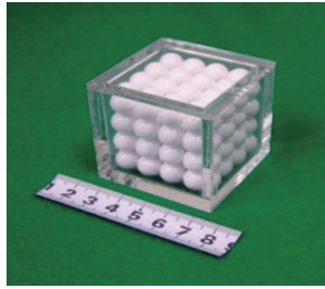
図7 空隙率測定用試験体 (アクリル樹脂, 単純立方構造)
