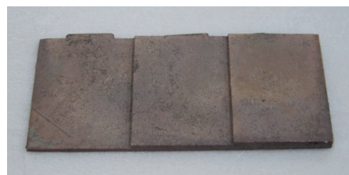
a) 生型で鑄造した試料
