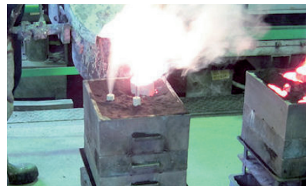
図15 銅合金鋳造試験の様子
