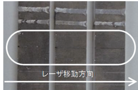
図22 レーザ発振停止によるビードの寸断 (A5052)
