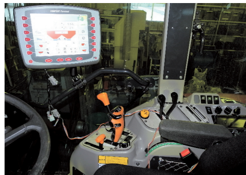
図2 バーチャルターミナルを装備したトラクタの運転席
