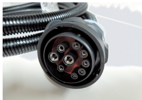
図4 作業機側のISOBUSコネクタ
