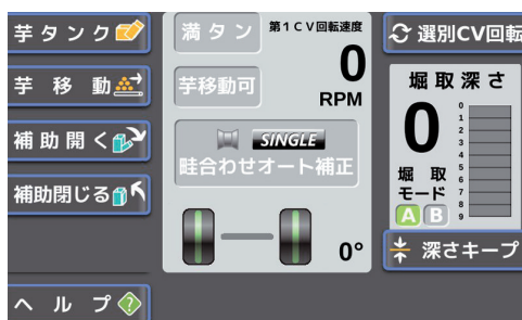
図15 ポテトハーベスタ側液晶操作端末の表示
