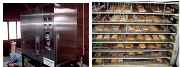
図1 凍結融解試験機と散水融解時の試験槽内の様子 (田尻機械工業(株)製, TM-622020)
