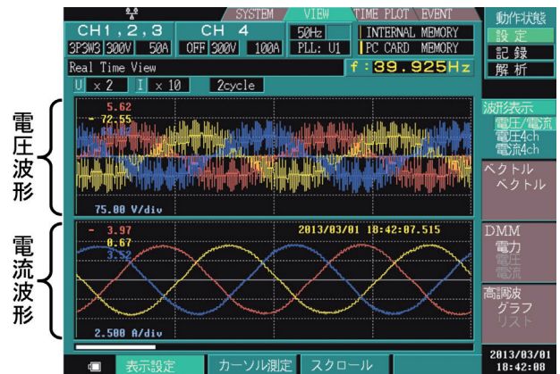
図7 モータ駆動時のインバータ出力例
