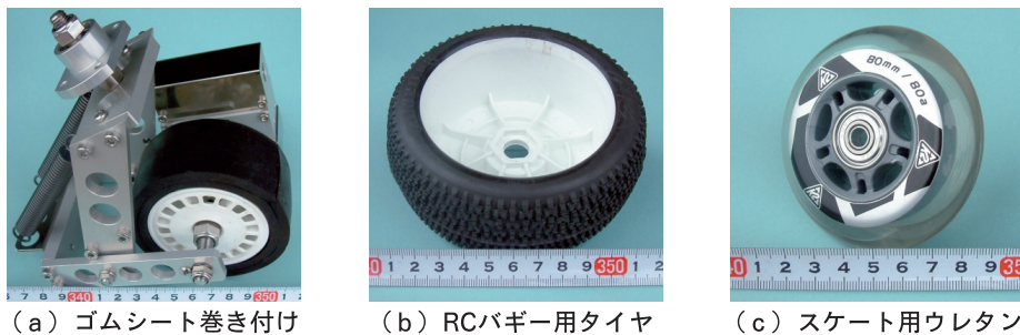
図5 摩擦係数の測定に供試したタイヤ各種
