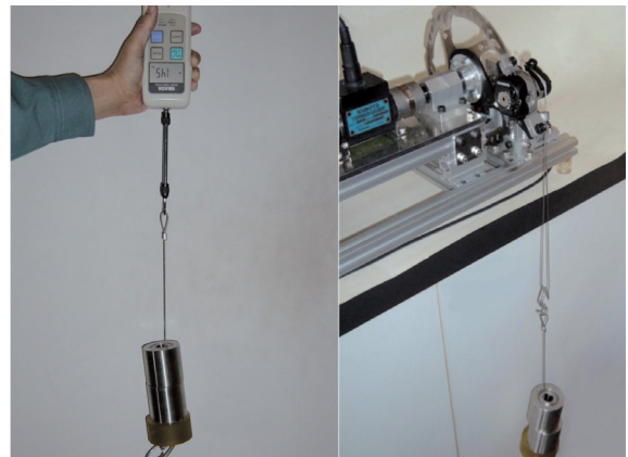
図16 重りの重量測定（左）と負荷変動測定風景（右）
