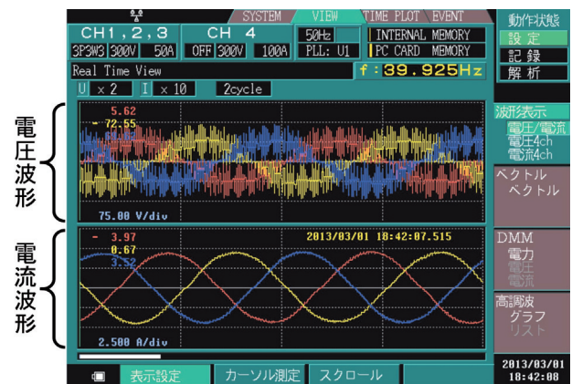
図7 モータ駆動時のインバータ出力例
