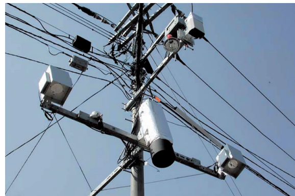
図2 従来の据置型路面凍結検知装置
