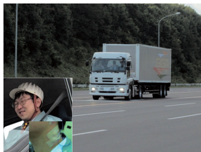
図2 走行試験車両と頸部振動センサ（左下）
