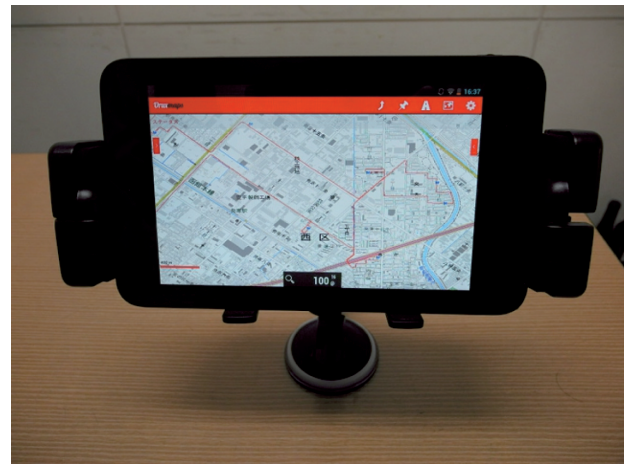
図2 走行軌跡記録・経路提示システム
