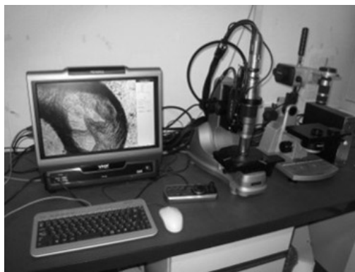
図1 デジタルマイクロスコープ（キーエンス製VHX-1000）
