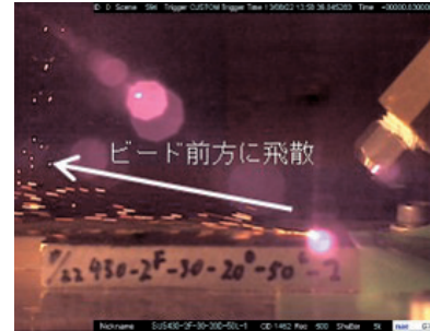
図10 高流速時のスパッタ挙動
