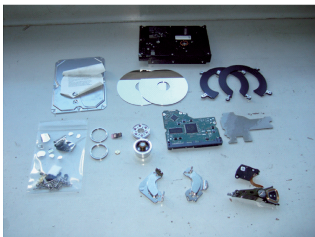
図1 3.5インチハードディスクドライブの解体
