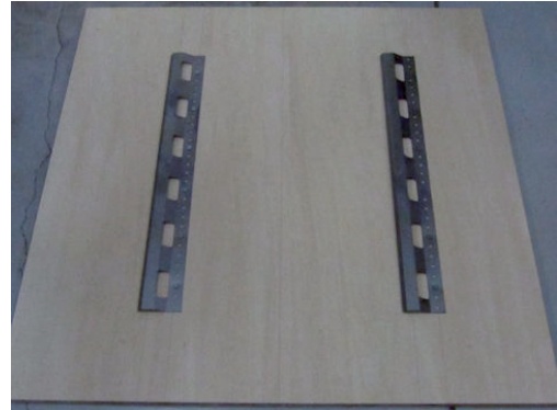
a) 防振鋼板の設置
