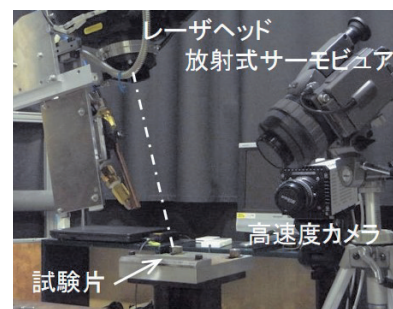
図5 高速度カメラ・サーモビュア観測系
