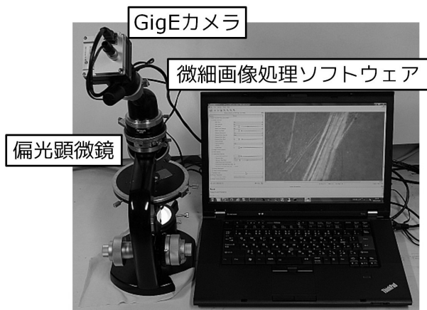
図10 試作したアスベスト識別検査装置
