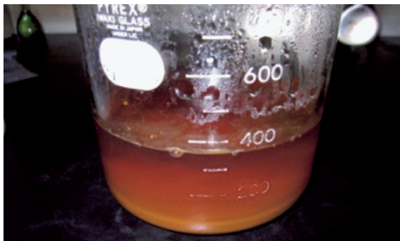
図14 ネオジウム磁石塩酸溶液の水酸化物沈殿処理
