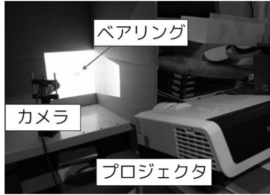
図20 プロジェクタ光源を用いて縞パターンを投影
