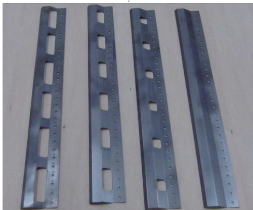
b) 窓孔形状の異なる防振鋼板
