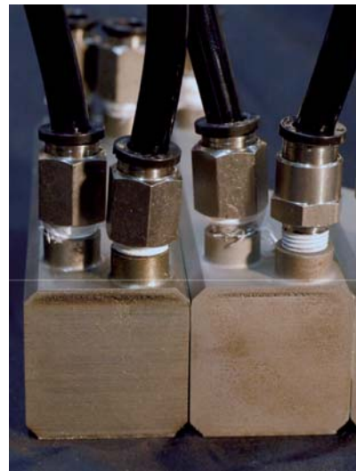
図 8 流体カップラにより多段化された熱交換構造体
