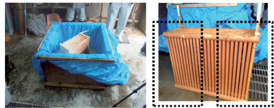
(a) スケール溶解実験状況 (b) 溶解剤浸漬箇所
