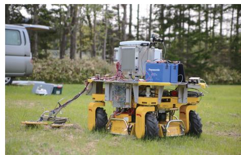
図12 センサを設置した実験用台車
