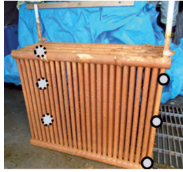
図29 熱交換器細管の外径の計測位置
