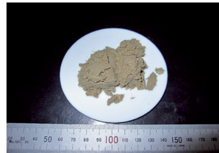
図3 ホタテガイ中腸線由来吸着剤の外観写真
