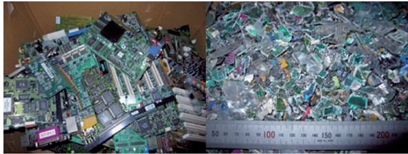
図1 破砕前後の電子基板
