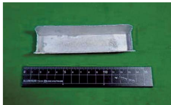
図6 AC7A試作鋳造品の外観写真
