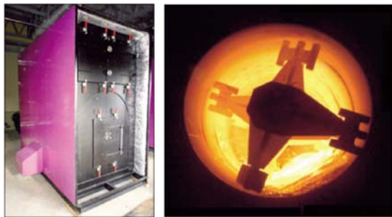
図11 開発したボイラと燃焼状態
