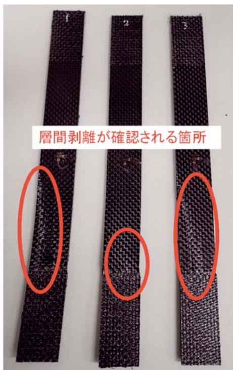
図5 引張破断後のCFRTP(PP)試験片
