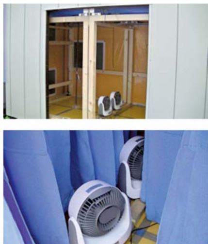
図27 攪拌用ファンの設置状況
