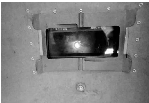
図12 視線計測装置による熟練者の視点 (防護面中央の○印)
